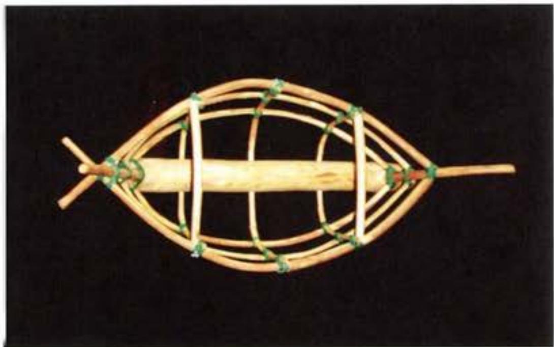
Илл. 2-3. Макет каркаса лодки композитной конструкции. Модель и фото: М. Иванов
